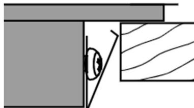
Для фиксации прибора с помощью 4-х скоб, найдите три винта на каждой из боковых сторон прибора, выкрутите средние винты, затем приложите скобы к боковым сторонам, сориентировав их как показано на рисунке выше, и вкрутите винты обратно, закрепив скобы.
